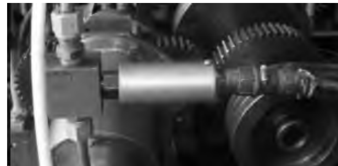
Конструктивна схема та встановлення на експериментальному стенді давача високого тиску
