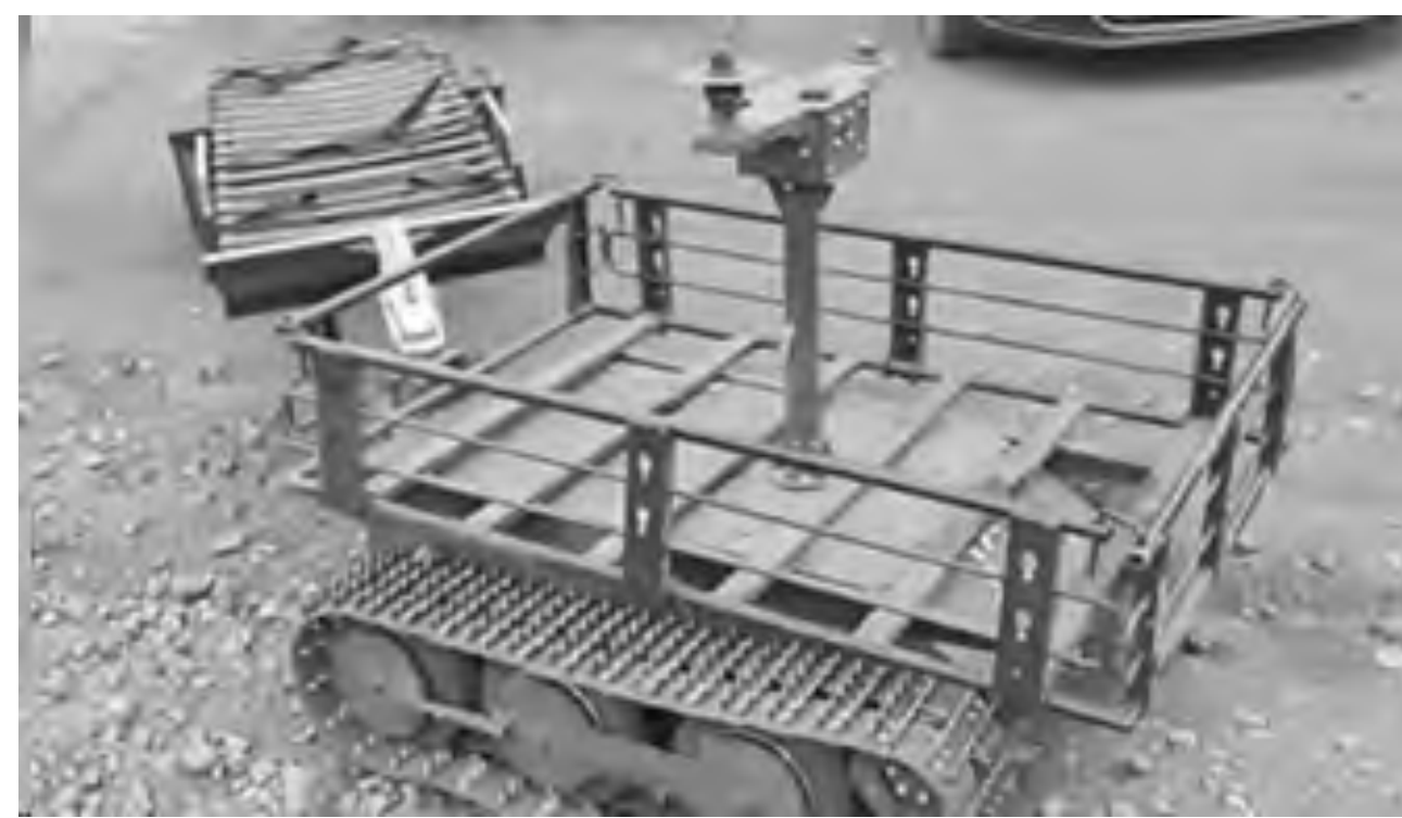
Багатоцільовий дрон «Вепр» з навісним обладнанням для розмінування та з навісним і причіпним обладнанням для вантажних перевезень та евакуації поранених
