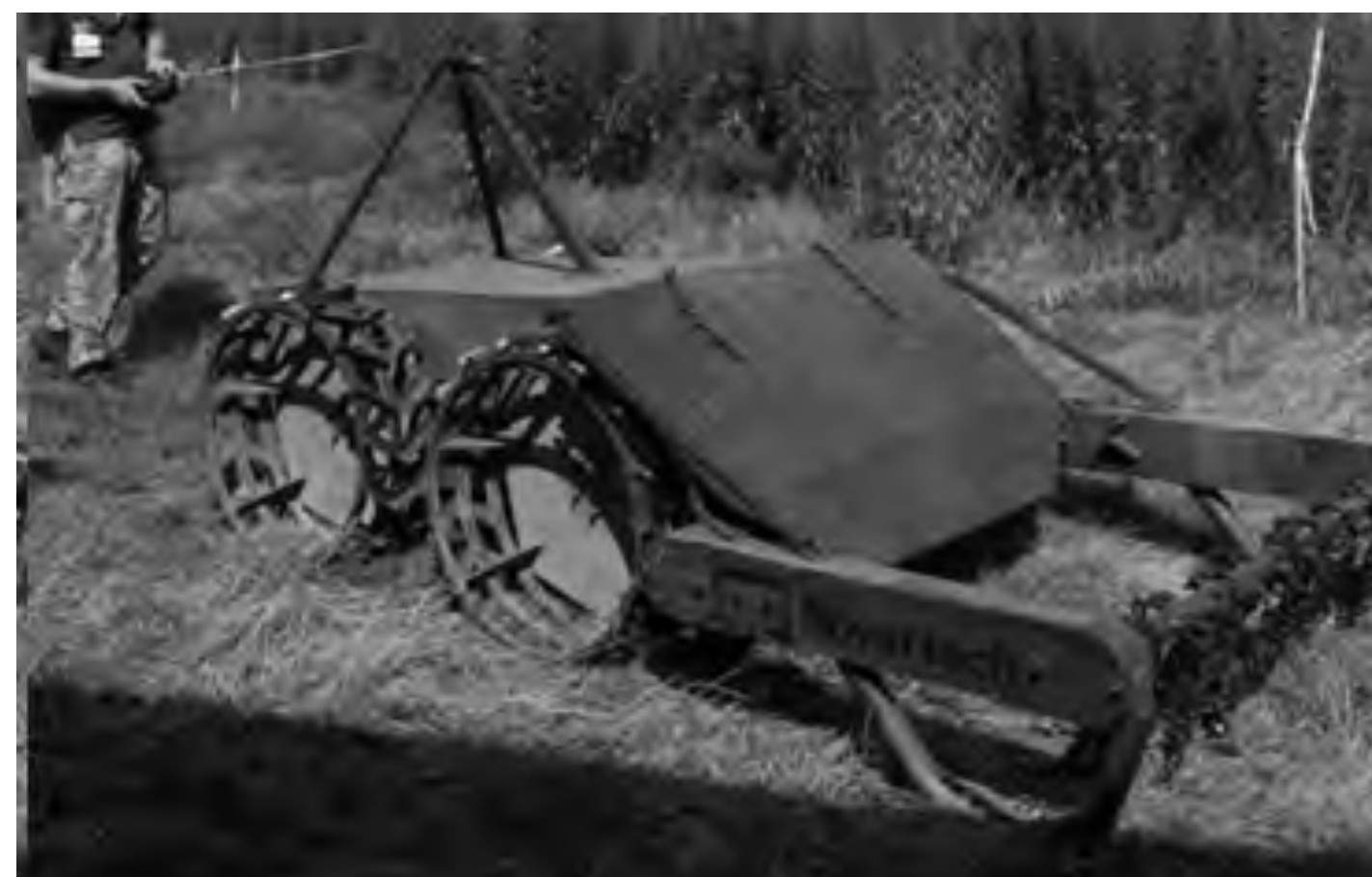
Багатоцільовий дрон «Вепр» з навісним обладнанням для розмінування та з навісним і причіпним обладнанням для вантажних перевезень та евакуації поранених
