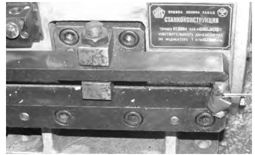
Рисунок 4.5 – Давач крутного моменту: а) конструктивна схема; б) на експериментальному стенді.
