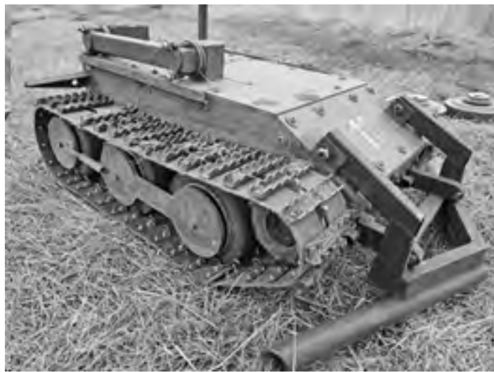
Багатоцільовий дрон «Вепр» з навісним обладнанням для розмінування та з навісним і причіпним обладнанням для вантажних перевезень та евакуації поранених
