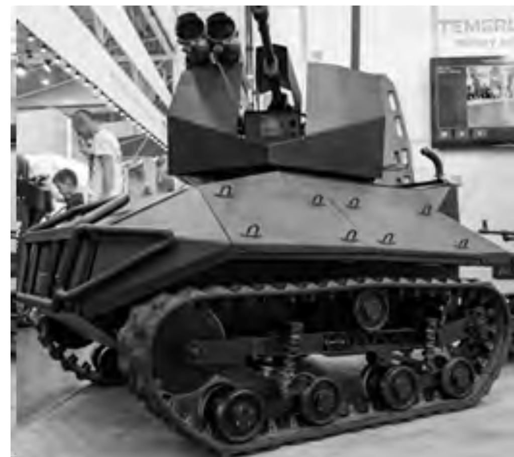
Багатоцільовий дрон «Вепр» з навісним обладнанням для розмінування та з навісним і причіпним обладнанням для вантажних перевезень та евакуації поранених
