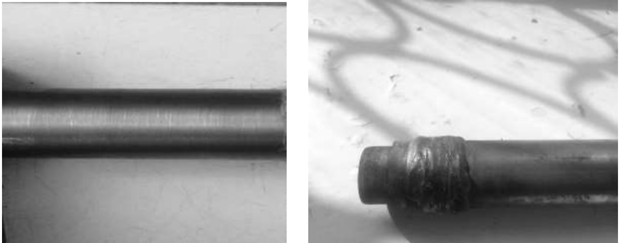
Рисунок.2.4 – Зразок до та після нанесення покриття
