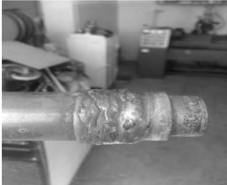
Рисунок.2.8 – Зразок після наплавлення
