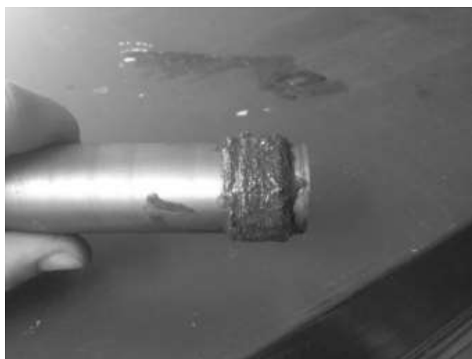
Рисунок. 2.7 – Заготовка з нанесеною комбінацією нитки та порошків
