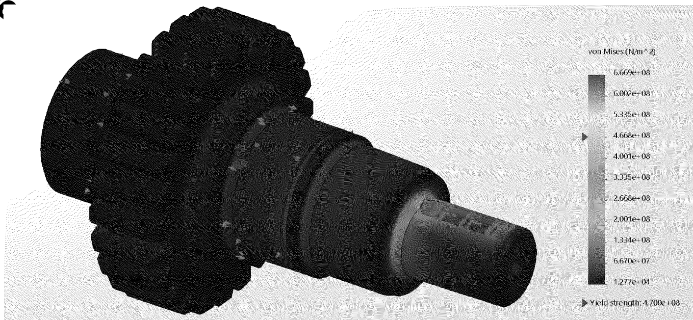
Рисунок 1.6 – Напруження по Мізсу для деталі «Вал-шестерня Д02210.5»
