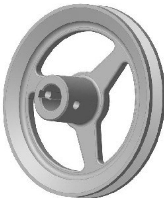
Рисунок 2.2 – 3D-модель деталі «Шків 028.КП.01.008»
