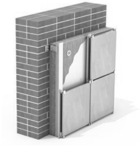
Рисунок 2.2 – Конструкція навісного вентиляваного фасаду
