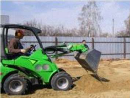
1 - розподіл піску навантажувачем
