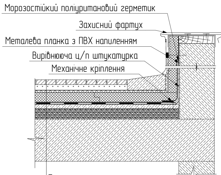
Парапет інверсійної експлуатуємої покрівлі
