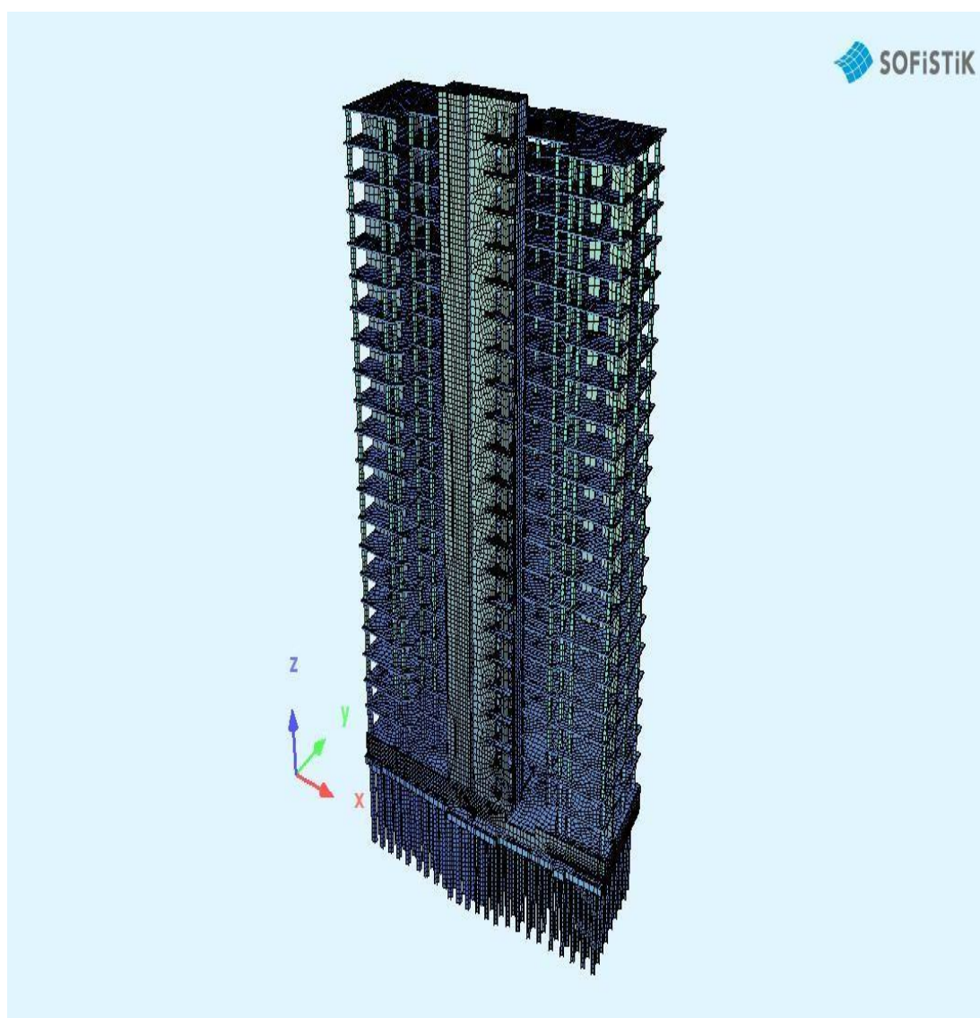
Рис. 2.5. Загальний вигляд моделі багатоквартирного будинку (програма «SOFISTIK»)
