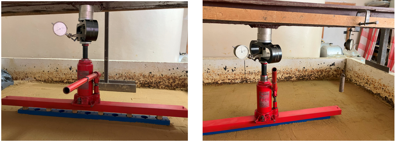
Рис. 2.5 – Процес випробування пальового фундаменту
