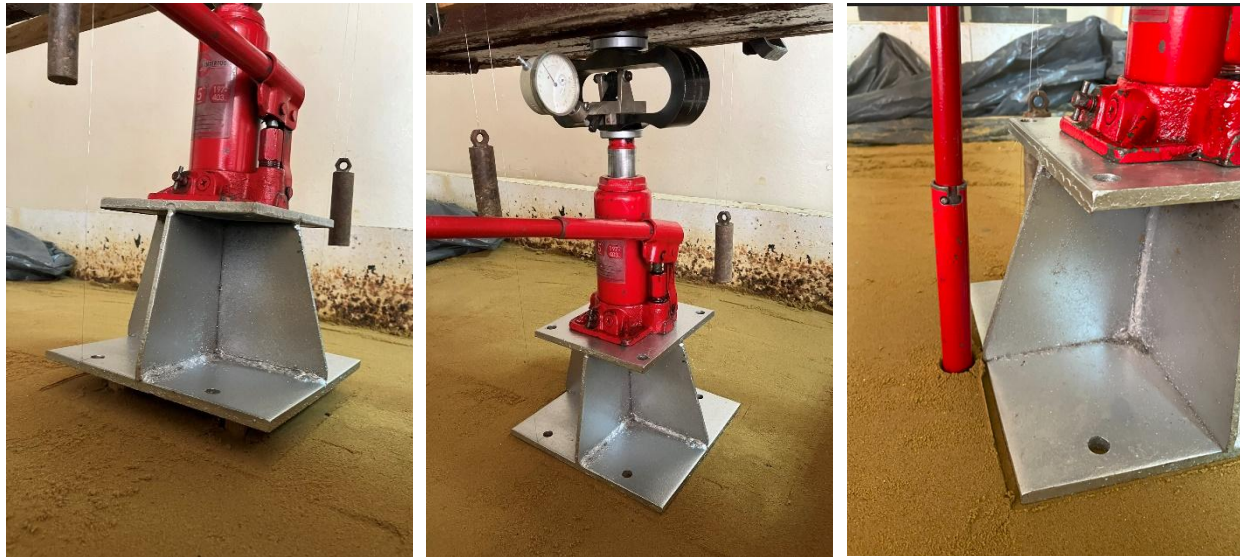
Рис. 2.6 – Процес випробування пальового фундаменту
