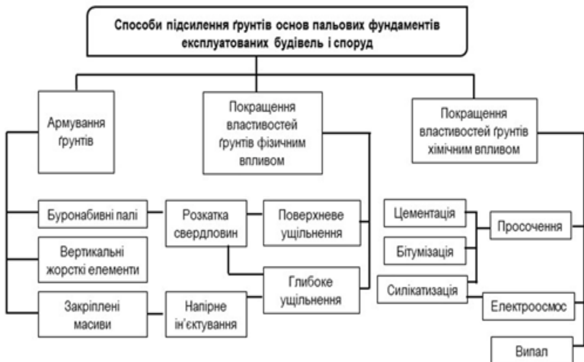
Рис. 1.3 – Способи зміцнення основ пальових фундаментів
