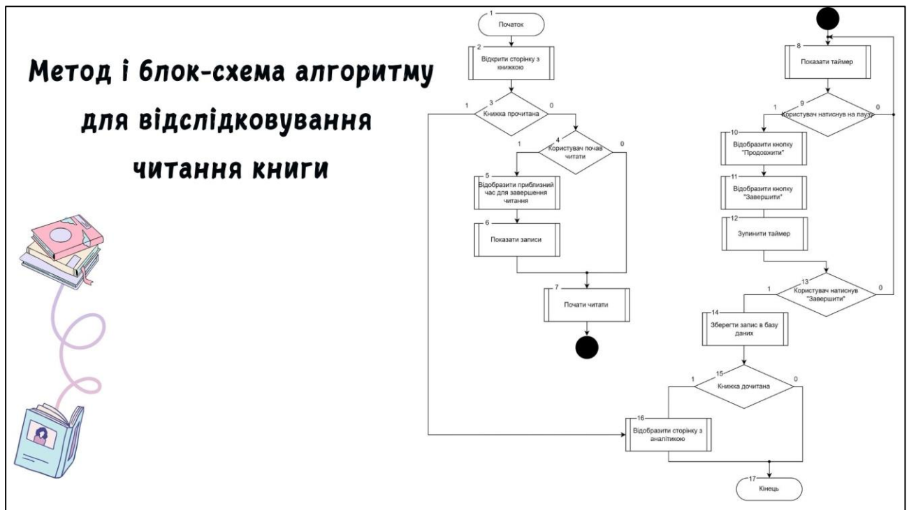
Рисунок Г.11 – Метод і блок-схема алгоритму для відслідковування читання книги
