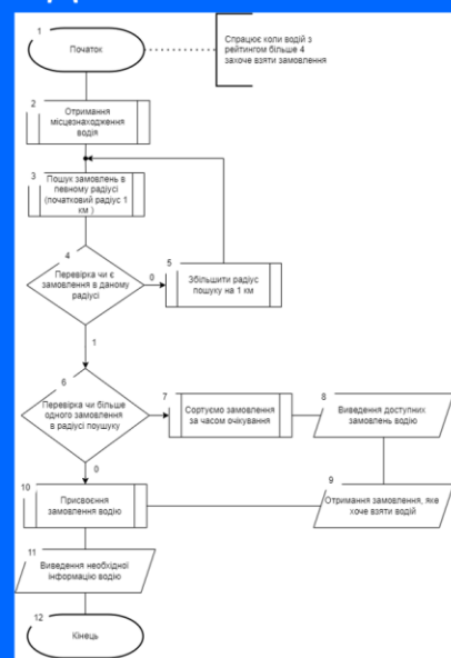
Рисунок Г.10 – Метод і блок-схема алгоритму оптимізації процесу видачі замовлень
