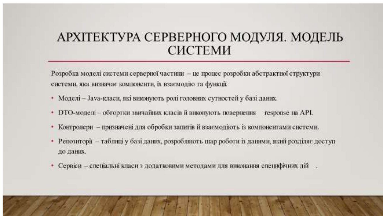
Рисунок Г.6 – Архітектура серверного модуля. Модель системи
