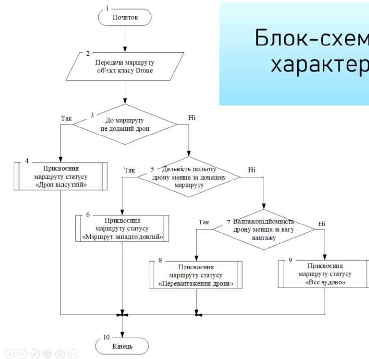
Рисунок Г.11 – Блок-схема методу врахування характеристик безпілотника
