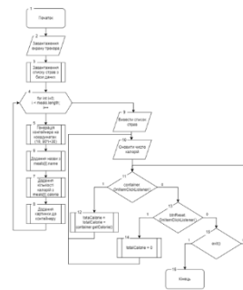
Рисунок Г.16 – Слайд «Алгоритм роботи модуля трекера калорій»
