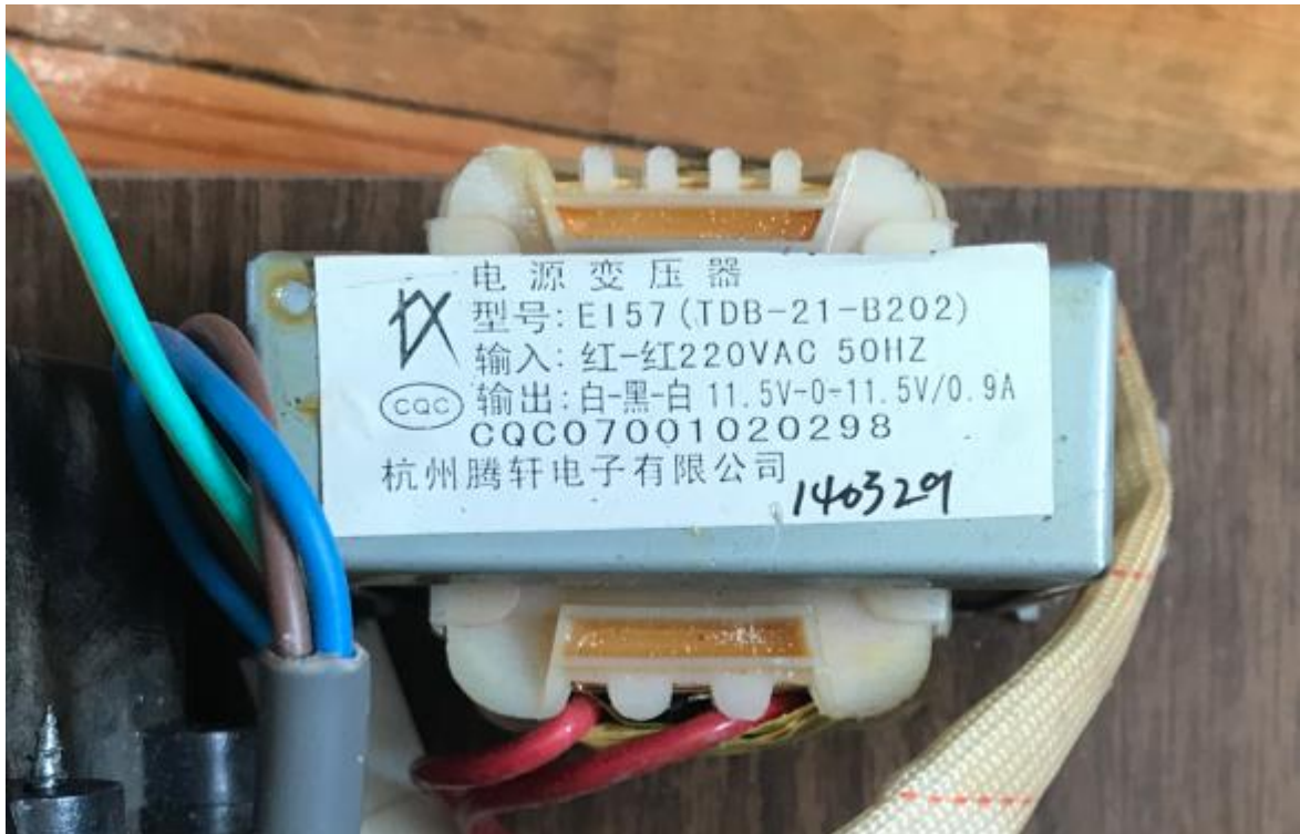
Рисунок 2.2 – Зовнішній вигляд понижуючого трансформатора напруги E157 (TDB-21-B202)
