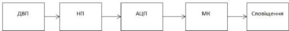
Рисунок 3.3 – Схематичне зображення потоку вимірювання вологості повітря.
