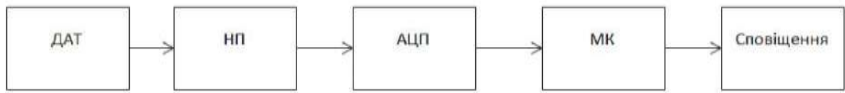
Рисунок 3.4 – Схематичне зображення потоку вимірювання атмосферного тиску.
