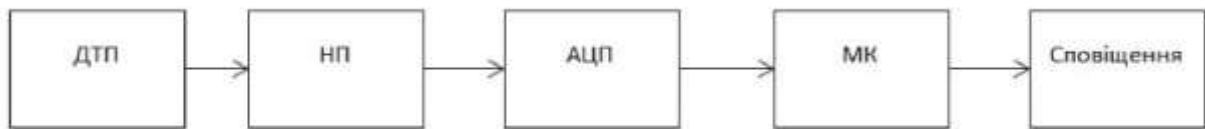
Рисунок 3.2 – Схематичне представлення каналу заміру температури повітря.
