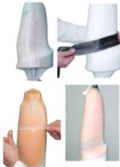
Рис. 2.4 – Виготовлення куксоприймальної гільзи методом ламінування
