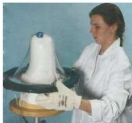
Рис. 3.3 – Виготовлення куксоприймальної гільзи із термопластичного листа (поліпропілен/ поліестер)
