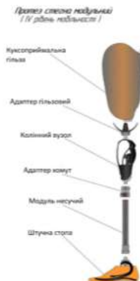
Рис. 1.11 – Детальна побудова протезного виробу стегна модульного типу IV ступеню мобільності
