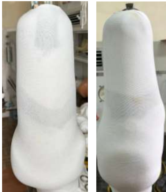
Рис. 2.8 – Розміщення гільзового адаптеру під час виготовлення куксоприймальної гільзи
