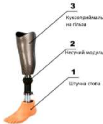
Рис. 1.8 – Загальна будова протезу гомілки модульного типу
