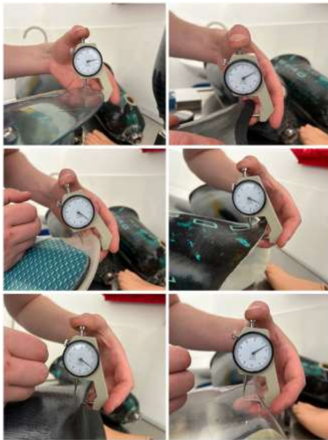
Рис. 3.7 – Виконання дослідів за допомогою механічного товщиноміра
