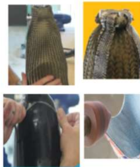
Рис. 3.4 – Виготовлення куксоприймальної гільзи із використанням базальтового волокна
