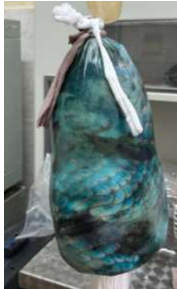
Рис. 3.3 – Виготовлення куксоприймальної гільзи із метакрилатної смоли із додатковим шаром тканини
