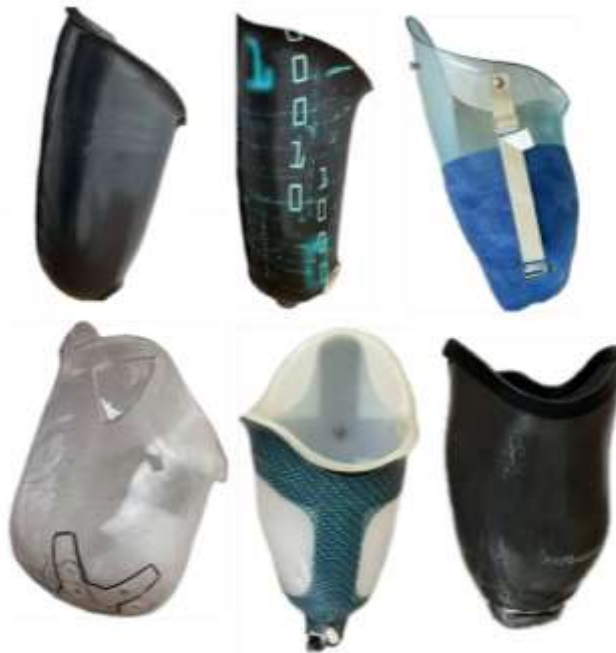
Рис. 3.5 – Куксоприймальні гільзи відібрані для проведення дослідження
