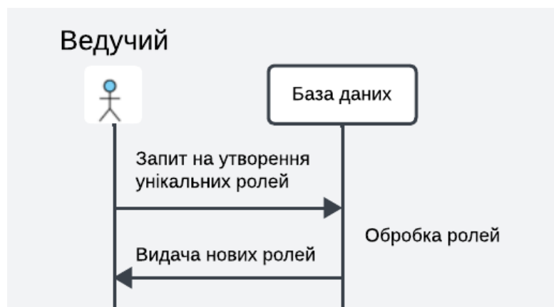
Рисунок 2.3 – UML-діаграма послідовності алгоритму отримання унікальних ролей
