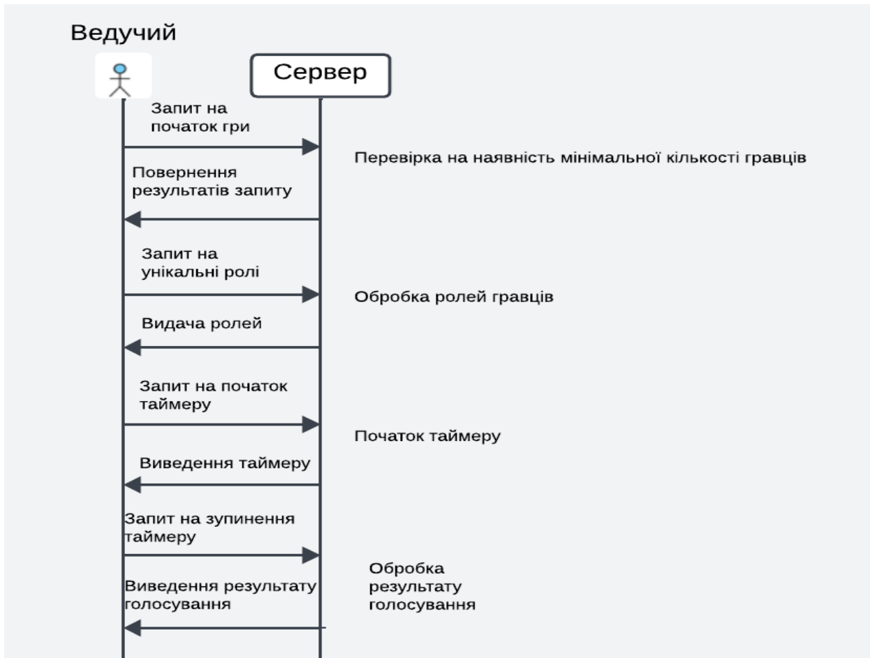
Рисунок 2.1 – UML-діаграма послідовності удосконаленого алгоритму роботи гри “Мафія”
