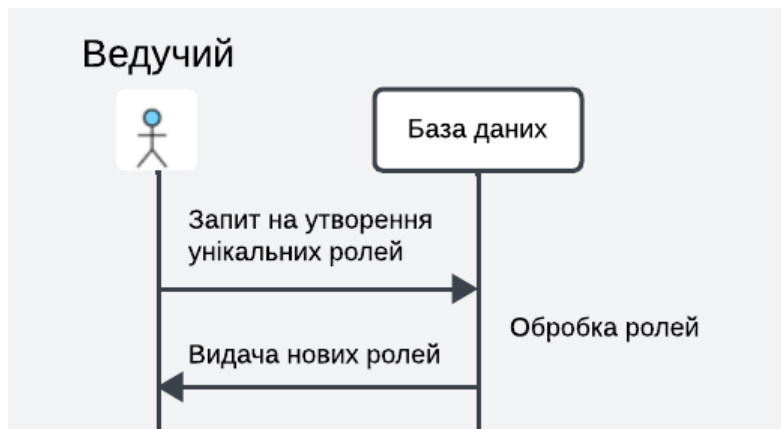
Рисунок 2.3 – UML-діаграма послідовності алгоритму отримання унікальних ролей
