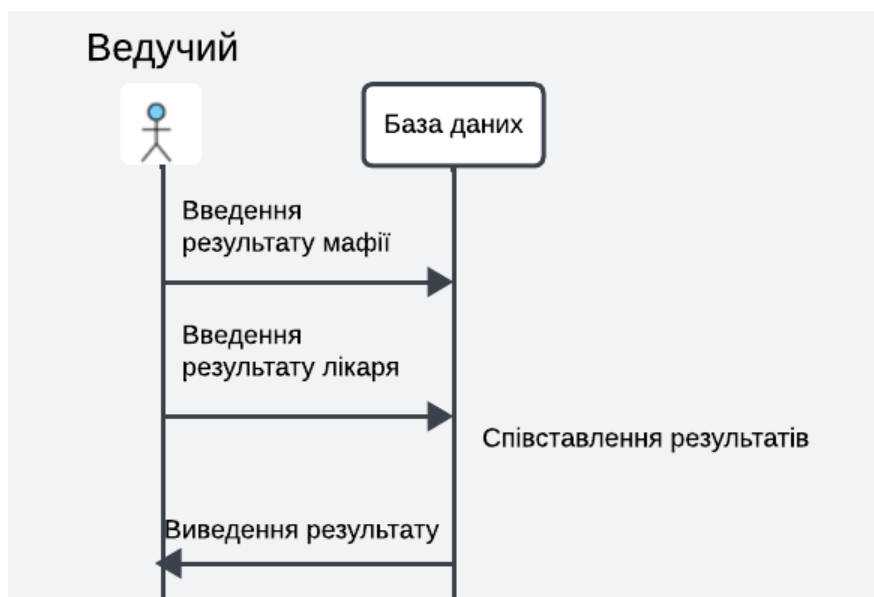
Рисунок 2.2 – UML-діаграма послідовності алгоритму вбивства та лікування
