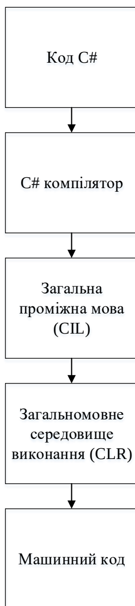
Рисунок 2.3 – Архітектура .NET Framework
