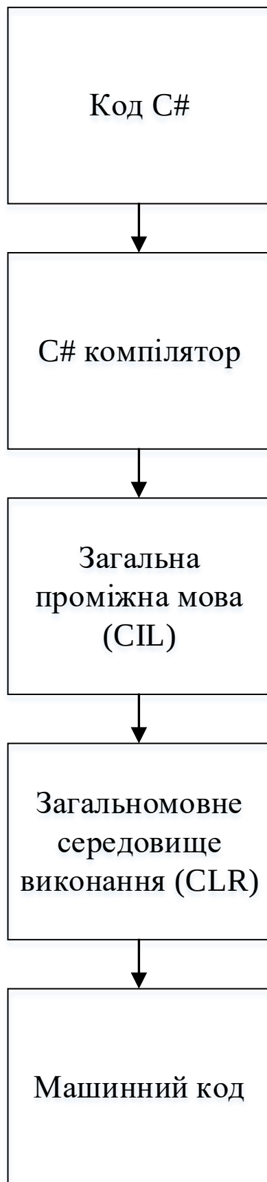
Рисунок В.3 - Архітектура .NET Framework
