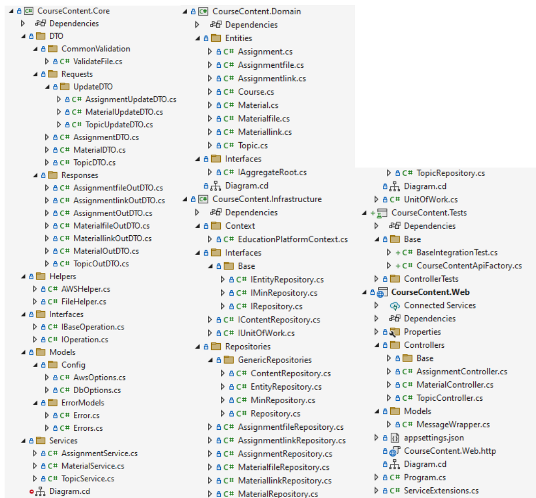
Рисунок Г.5 – Файлова структура модуля адміністрування контенту
