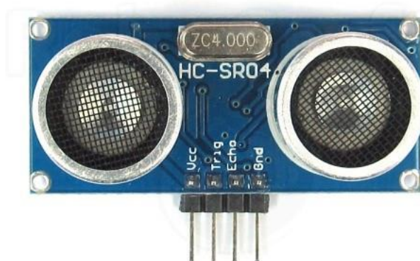
Рисунок 2.9 – Зовнішній вигляд ультразвукового датчика HC-SR04
