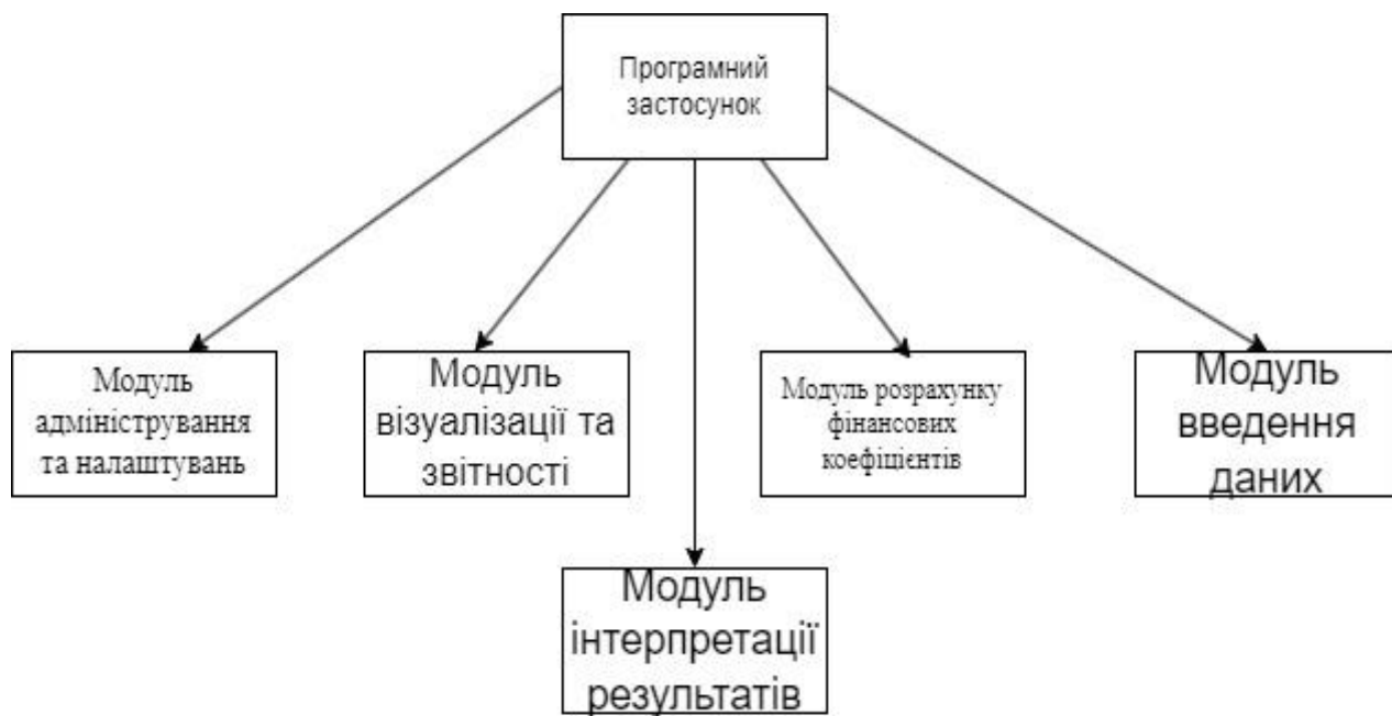
Рисунок Г.1 – Структура програмного модуля додатку
