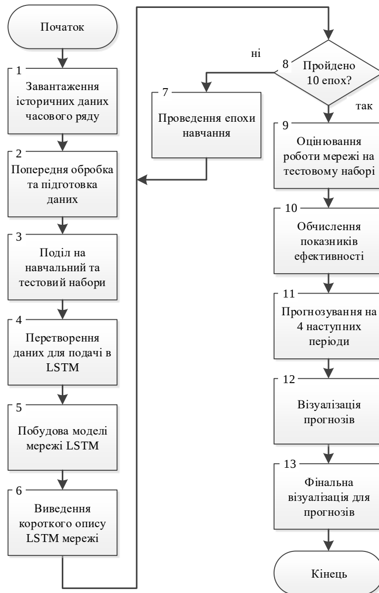
Рисунок 2.2 – Схема алгоритму роботи програмного модуля прогнозування часових рядів
