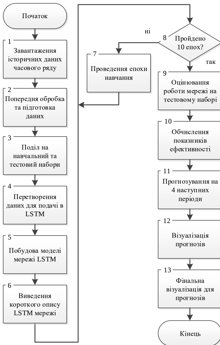
Рисунок В.1– Схема алгоритму роботи програмного модуля прогнозування часових рядів
