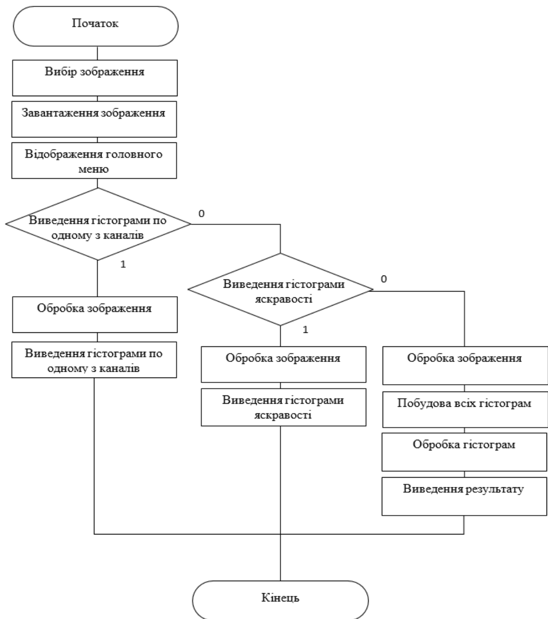
Рисунок Г.5 – Схема алгоритму роботи програмного модуля цифрової обробки зображень
