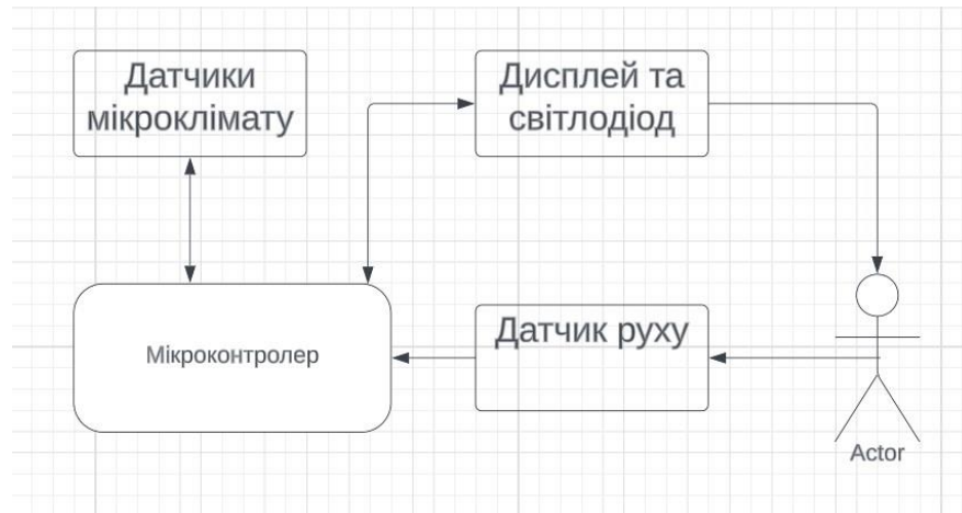
Рисунок 2.2 – UML діаграма комунікації програмно-апаратного модуля управління кліматом на основі платформи Arduino
