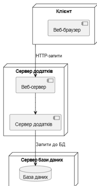
Рисунок В.5 – UML-діаграма розгортання серверної частини WEB-сервісу.
