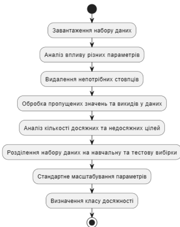
Рисунок В.2 – Схема алгоритму роботи модуля класифікатора визначення досяжності мети.
