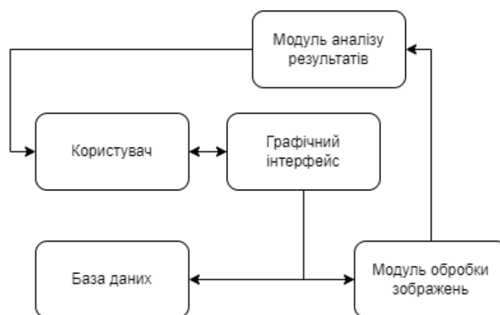
Рисунок 2.4 – UML-діаграма комунікації системи програмного модуля для розпізнавання облич
