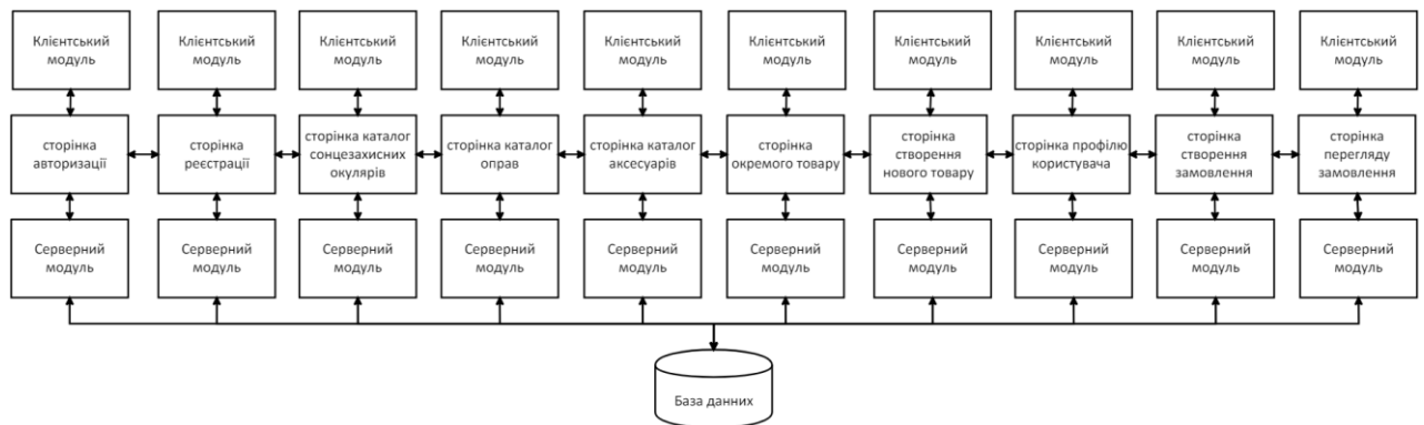
Рисунок Г.7 – Загальна структурна схема функціонування системи
