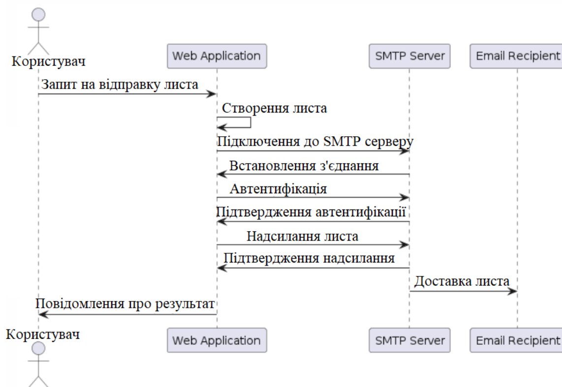
Рисунок Г.2 - Типова схема взаємодії WEB-додатка із SMTP сервером
