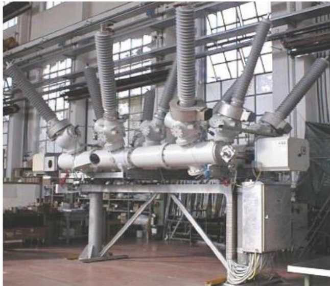
КОМІРКА З ДВОМА СИСТЕМАМИ ЗБІРНИХ ШИН
