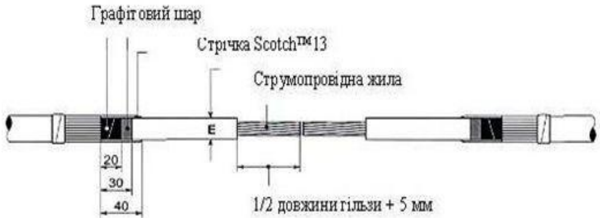
Рисунок 7.9 – Монтаж кабельної муфти, етап третій
