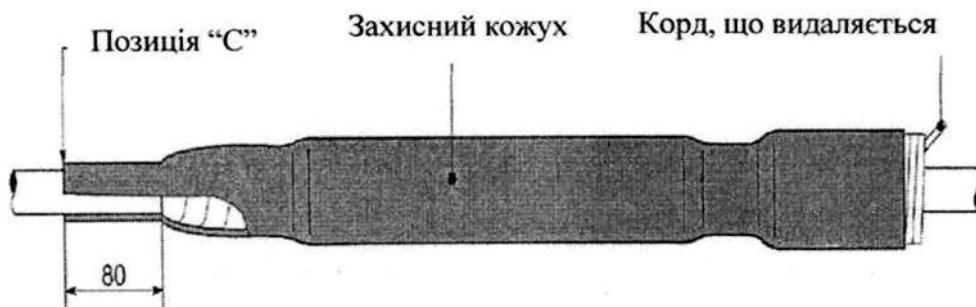
Рисунок 7.15 – Монтаж кабельної муфти, етап дев'ятий
