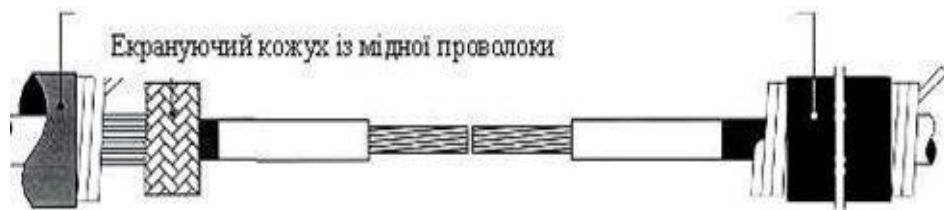
Рисунок 7.10 – Монтаж кабельної муфти, етап четвертий
