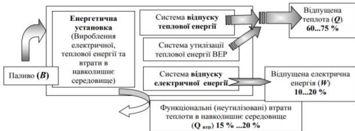
Рисунок 3.1 – Структура енергетичної когенераційної установки
