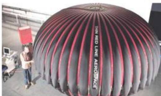
Резервуар для зберігання стисненого повітря
