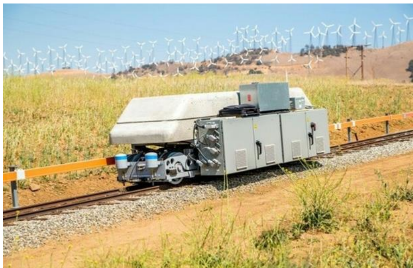
Рисунок 1.12 Гравітаційний накопичувач електроенергії вагонеткового виконання
