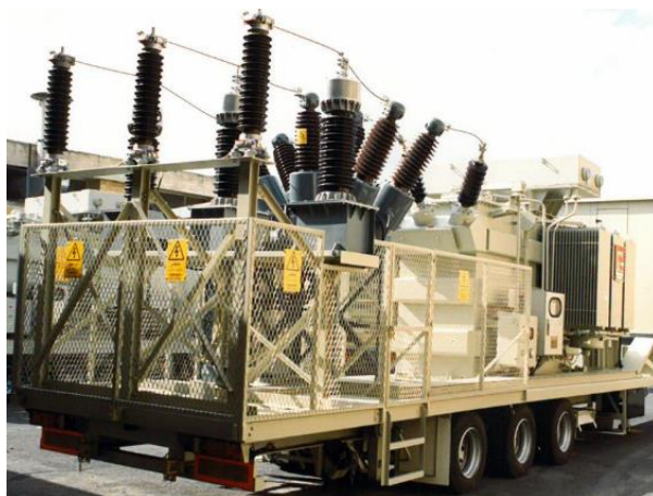
Рис. 2.23 Мобільна підстанція фірми MEDELEC[22]
