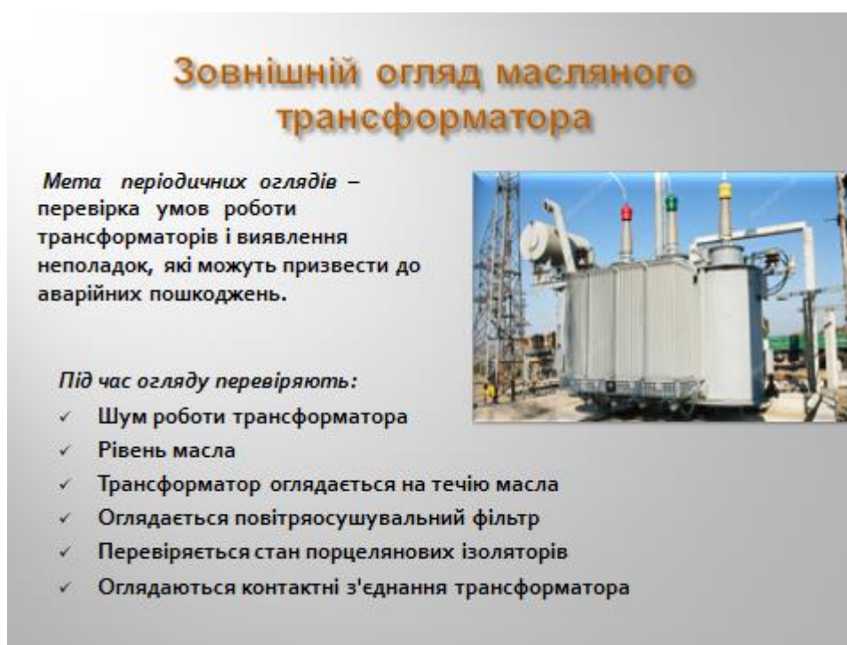
Рисунок 2.4-Види перевірок під час огляду трансформаторів
