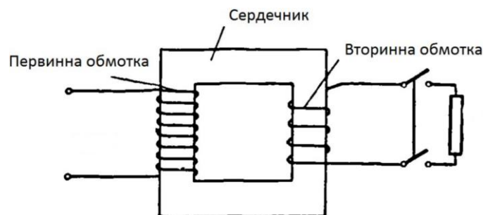
Рисунок 1.1 – Типова спрощена схема трансформатора струму
