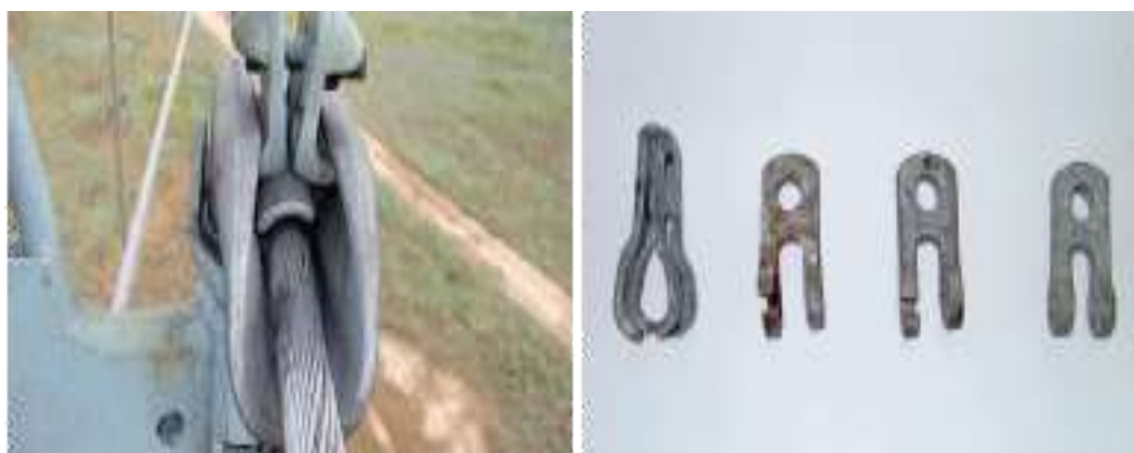
Рисунок 1.10 – Руйнування елементів ПЛ від танців проводів
