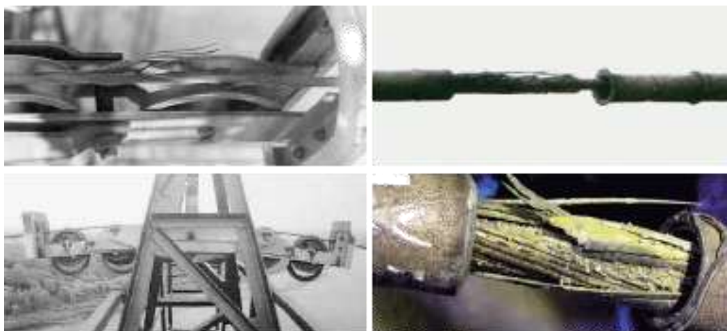
Рисунок 1.6 – Характерні пошкодження роликів підвісів та грозозахисних тросів, проводів у роликів підвісах
