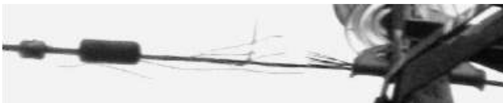
Рисунок 1.8 – Руйнування дроту АЖС
