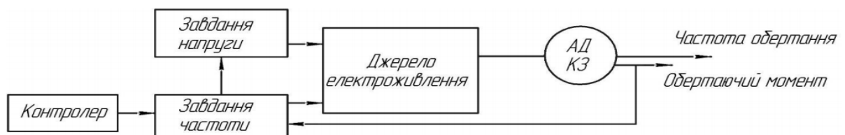
Рисунок 8.1 – Спрощена структурна схема асинхронного приводу електрокари
