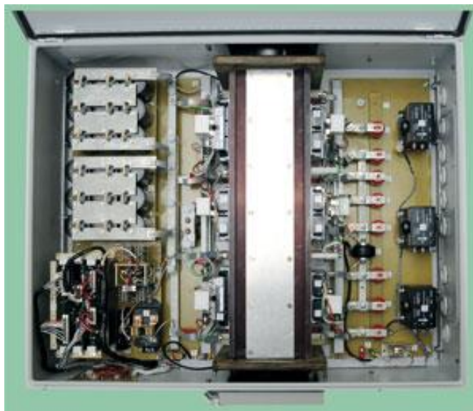
Рисунок 6.2 – Вигляд внутрішньої частини тягового перетворювача
