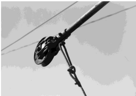
Рисунок 1.1 – Рання конструкція штангового струмознімача
