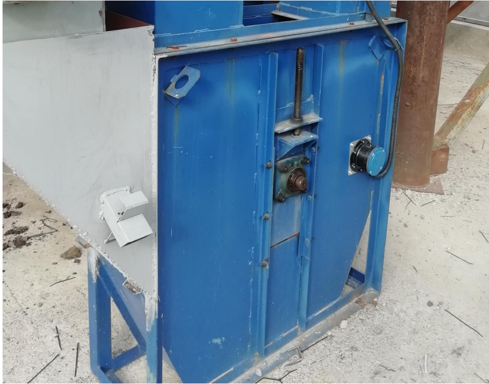
Рисунок 3.4 – Розміщення сенсора підпору норії вивантаження сушарки
