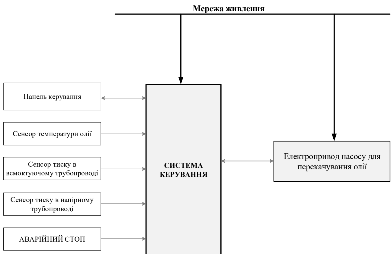
Рисунок 3.1 – Схема функціональна системи керування насосу для перекачування олії
