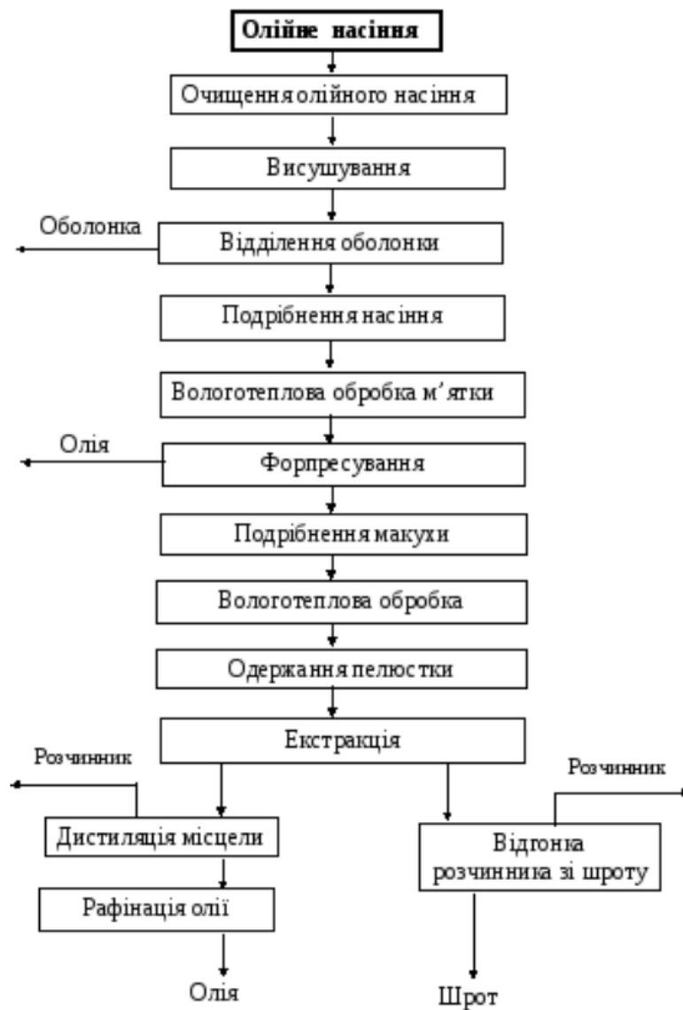
Рисунок 1.4 – Вилучення рослинної олії екстракцією з попереднім видавлюванням на шнекових пресах
