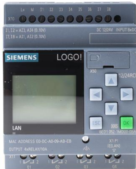
Рисунок 3.2 – Зовнішній вигляд ПЛК LOGO!12/24RCE
