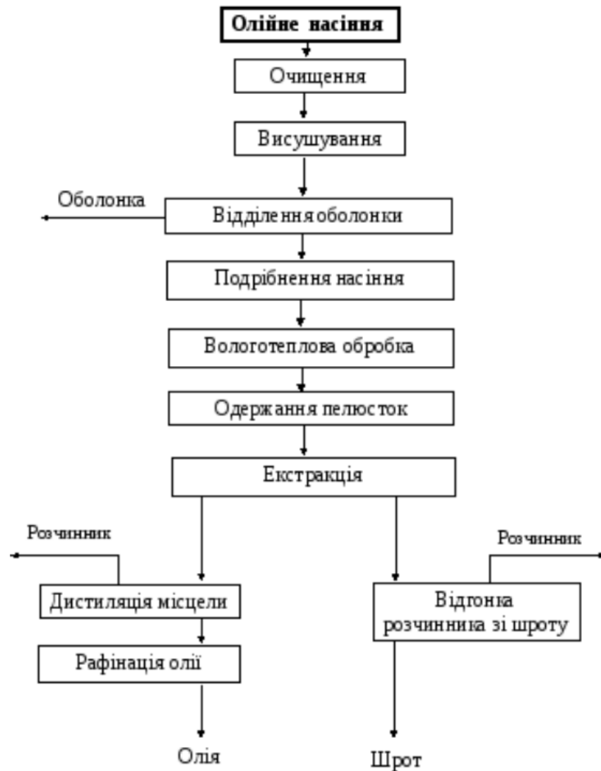
Рисунок 1.3 – Вилучення рослинної олії способом прямої екстракції
