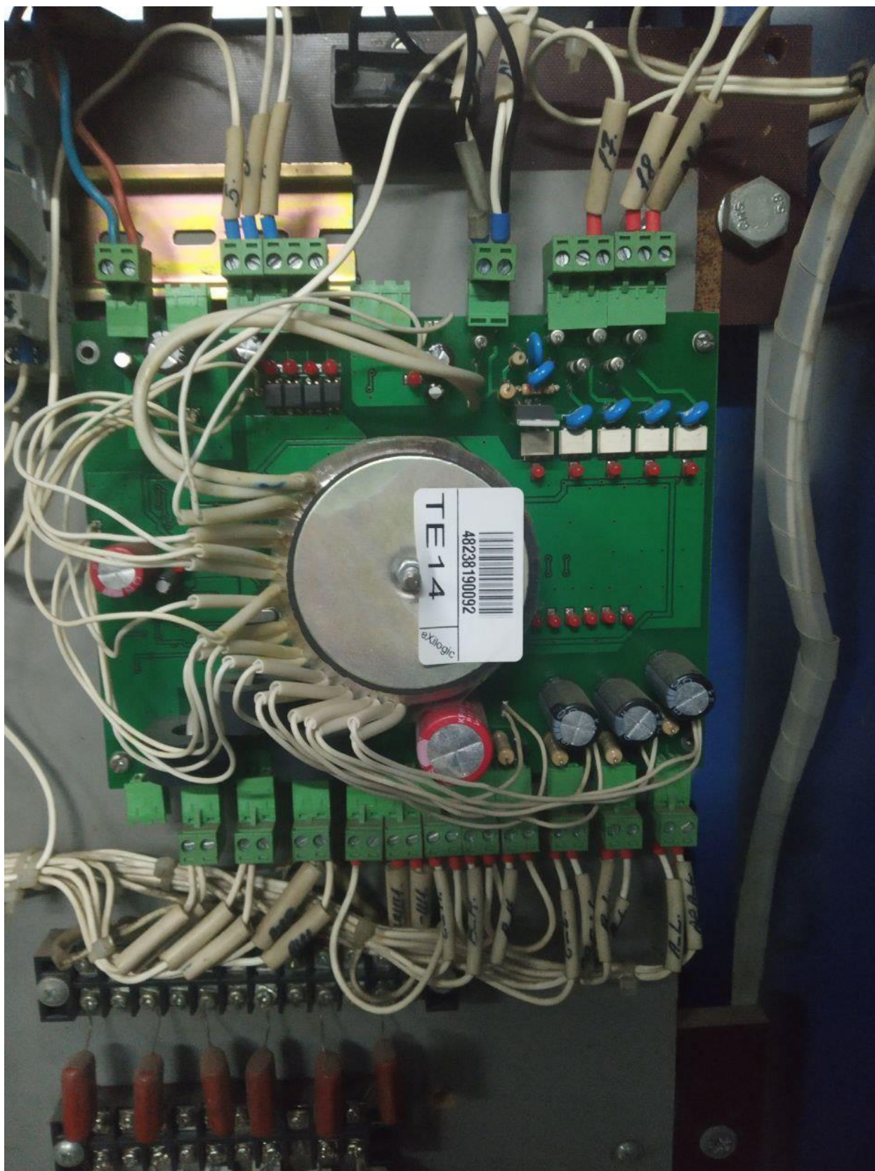
Рисунок 5.4 – Фото системи керування керованим випрямлячем Система керування КВ Exilogic TE4 – серія випрямлячів, які інтегруються в систему керування через RS485 з підтримкою Modbus RTU.
