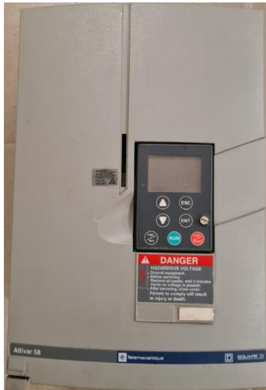
Рисунок 6.6 – Зовнішній вигляд перетворювача частоти
