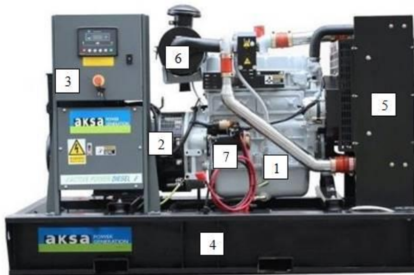
Зовнішній вигляд генераторної установки АК-4150
