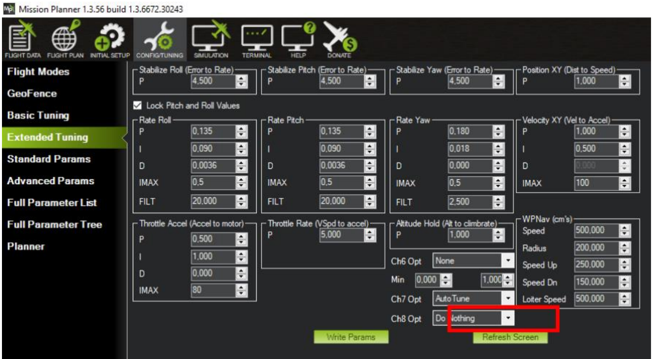
Рисунок 7.11 – Вікно Extended Tuning та прив'язка функції Auto Tune до 7-го каналу
