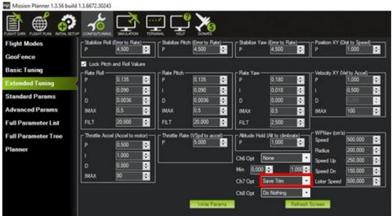
Рисунок 7.12 – Вікно Extended Tuning та прив'язка функції Save Trim до 7-го каналу
