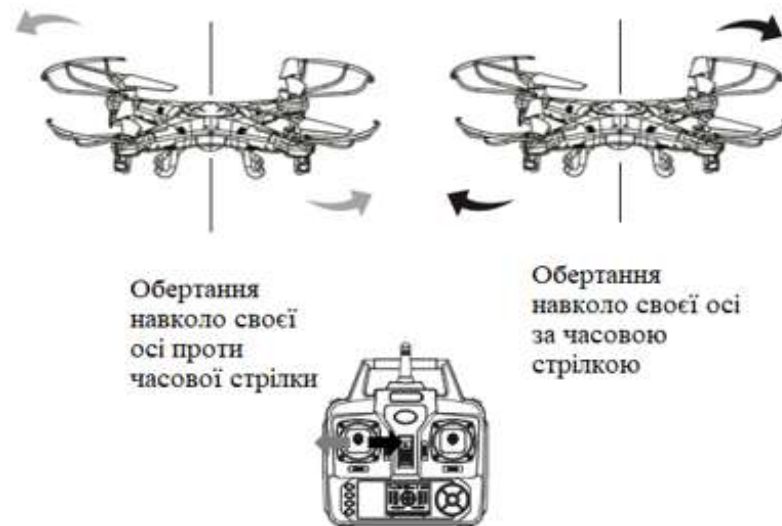
Рисунок 2.3 – Принцип керування БПЛА
