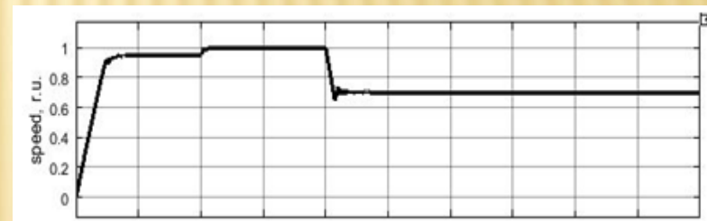
Рисунок 7.2 – Комп'ютерна модель електропривода при прямому пуску без зворотних зв'язків
