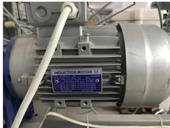
Рисунок 3.1 – Зовнішній вигляд асинхронного двигуна з короткозамкнутим ротором MS 90L1-4 1.50KWB5 виробництва INDUKTOR MOTOR
