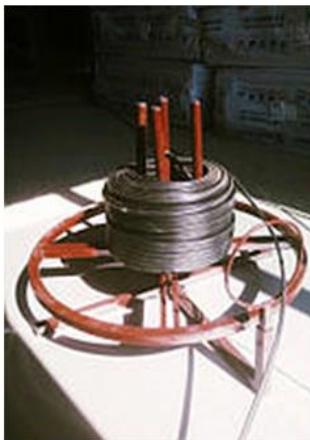
Рисунок 1.1 – Ручні пристрої намотування електричного кабелю
