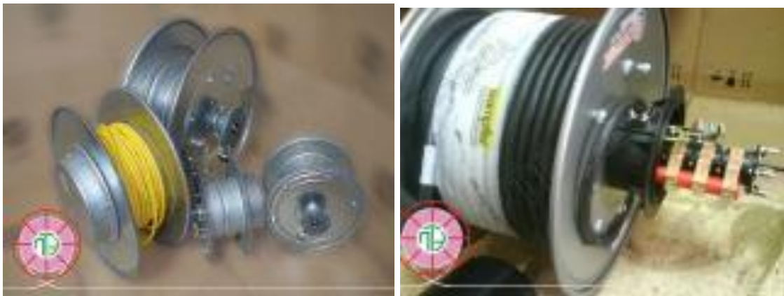
Рисунок 1.3 – Засоби підрахунку числа обертів кабельних барабанів
