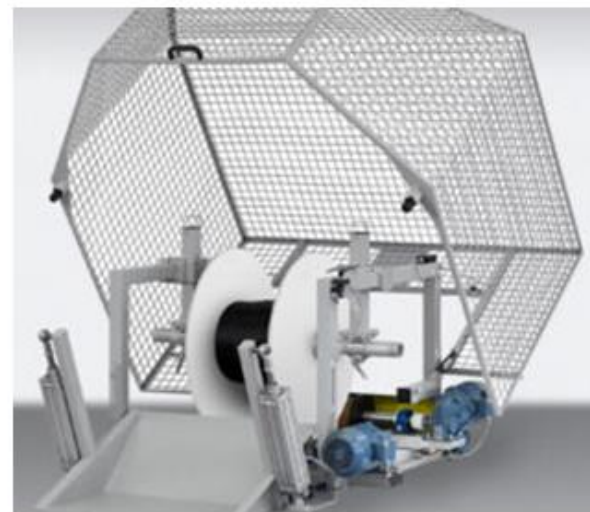
Рисунок 1.2 – Механізовані пристрої намотування електричного кабелю
