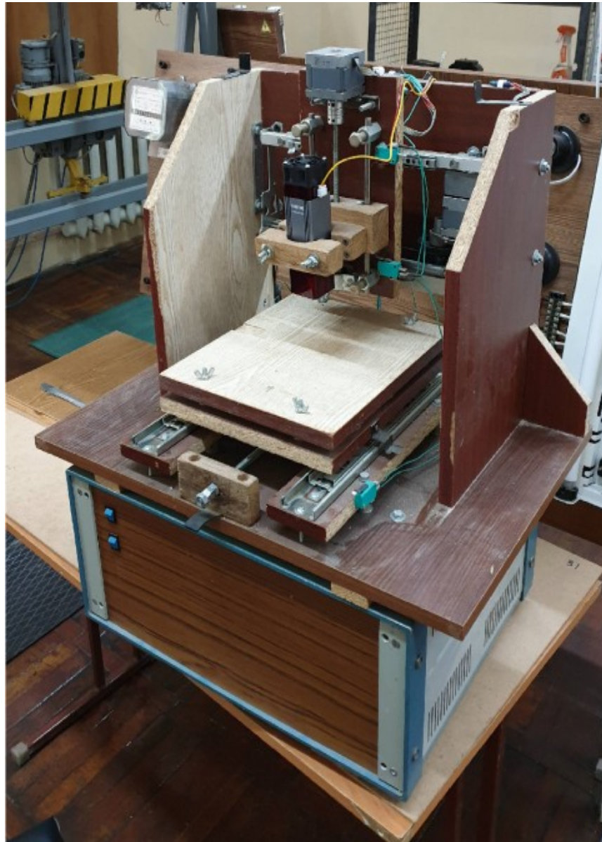
Рисунок 2.1 – Наявний гравірувальний верстат з ЧПК
