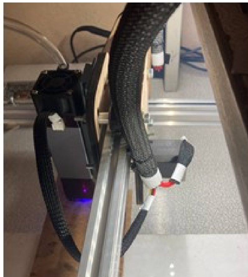
Рисунок 34 - Закріплена гофра на поперечній каретці
