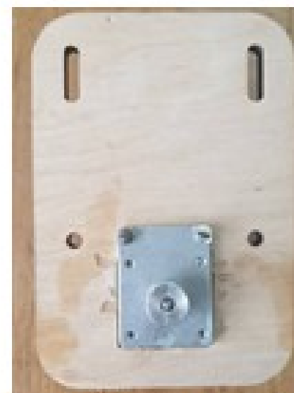
Рисунок 26 - Встановлення крокового двигуна в каретку
