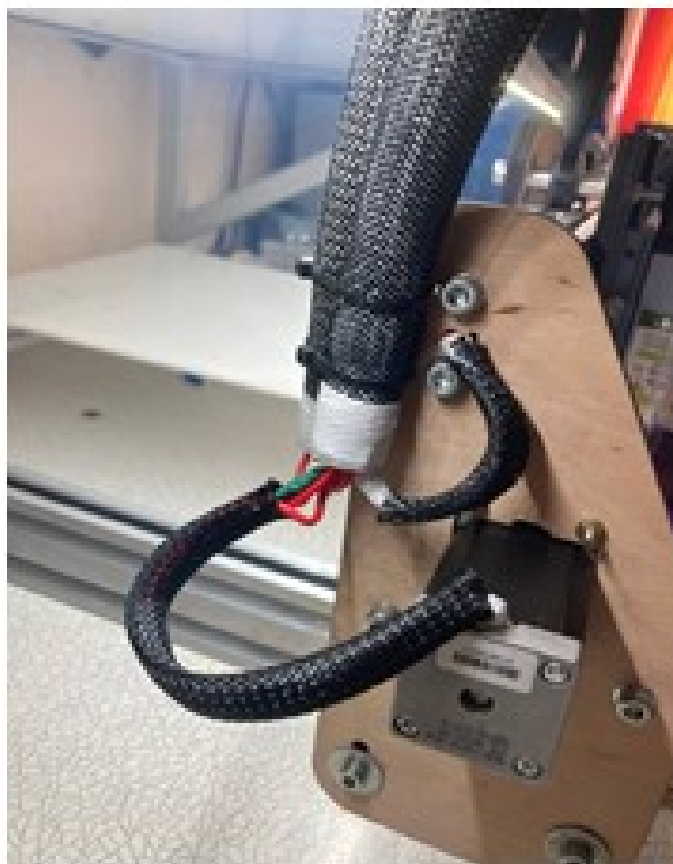
Рисунок 33 - Закріплена гофра на повздовжній каретці
