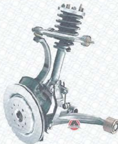
Рисунок 1.5 - Передня підвіска на двох поперечних важелях з амортизаційною стійкою
