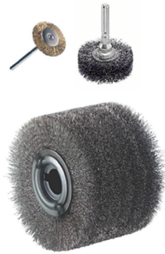
Рисунок 1.1 – Загальний вигляд інструменту для крацювання
